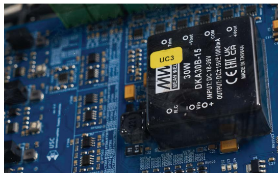
Электрические платы собственного изготовления покрыты двойным слоем лака
