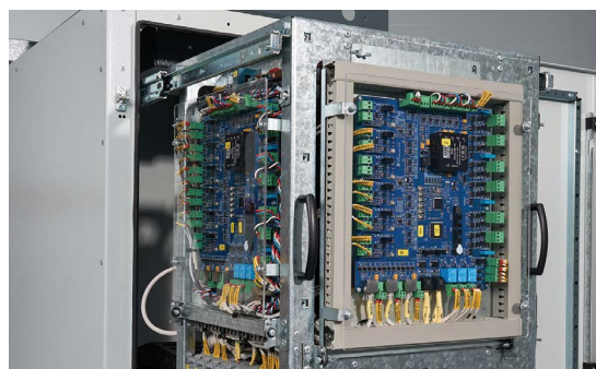
Силовой выдвижной модуль. Патент 222928
